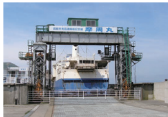
岸壁と船の間に貨車を積み込むための橋(可動橋)と船尾扉
