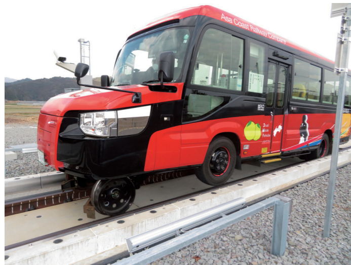
鉄輪をレールに乗せ前輪ゴムタイヤを浮かすDMV=阿波海南駅で
